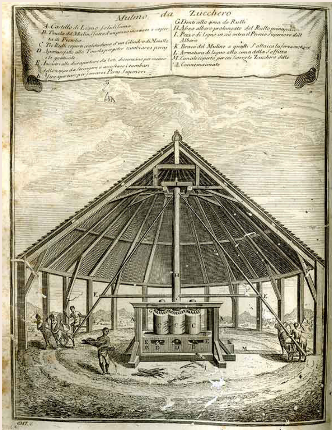
Grabado que muestra un molino de tracción manual para la fabricación del azúcar de caña.
